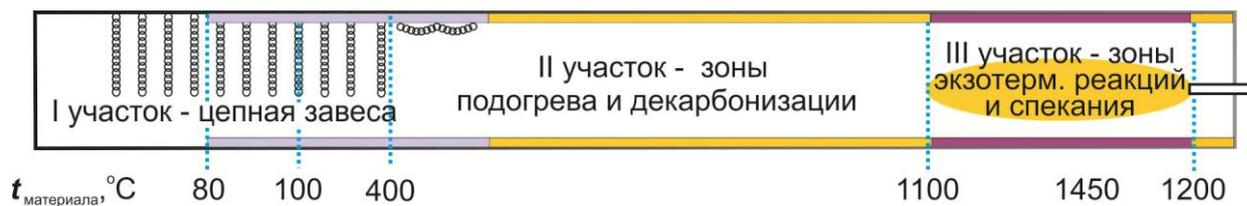
Рисунок 2.52 — Футеровка вращающейся печи мокрого способа производства
