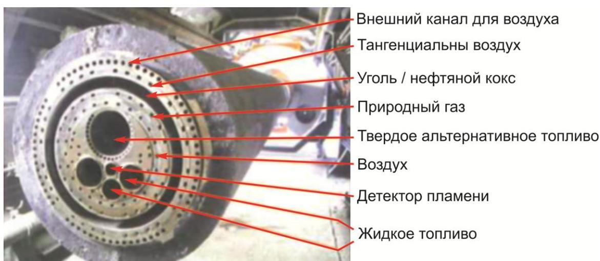
Рисунок 2.33 — Многоканальная горелка Flexiflame компании GRECO
