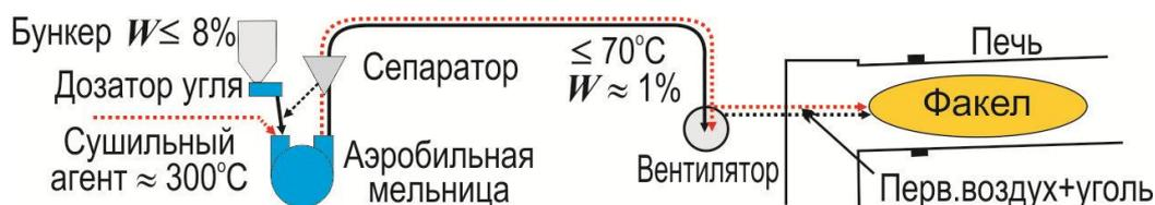
Рисунок 2.26 — Система прямого вдувания угольного порошка в печь<sup>1)</sup>
